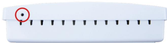
Rysunek 17: Przycisk parowania w czujnikach temperatury TS.
