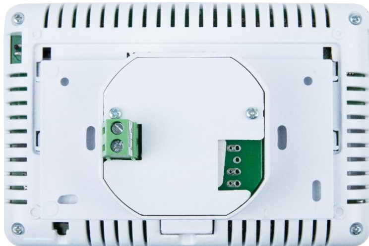
Rysunek 3: Budowa panelu sterującego CP10 – połączone obie części.
