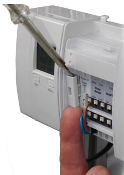
2. Снимите держатель предохранителя.
