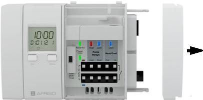
2. Снимите торцевую крышку.
