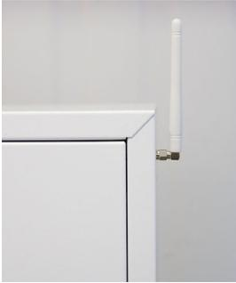
Если прием сигнала недостаточен при использовании клеящейся антенны в шкафу, вы можете установить антенну с угловым SMA-разъемом на внешней стороне шкафа.
