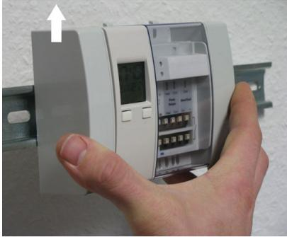
1. Слегка приподнимите модули (основной модуль и модуль управления) и наклоните их верхние части в сторону от монтажной рейки DIN.
