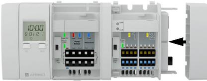
5. Установите торцевую крышку на последний модуль управления.
