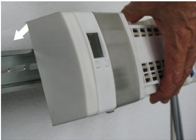
1. Закрепите верхние крючки модулей (основного модуля и модуля управления) на DIN-рейке.
