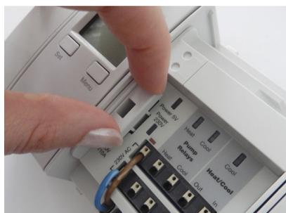
4. Вставьте держатель предохранителя в отсек для предохранителей.
