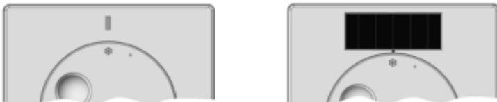
Rys. 28: Czujnik temperatury pokojowej jest ustawiony na ochronę przed zamarzaniem (8 °C)
