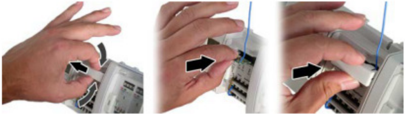
Rys. 21: Instalacja nadajnika radiowego FM z anteną przewodową
