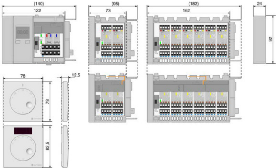
Rys. 7: Wymiary poszczególnych elementów systemu (wymiary podano w mm)
